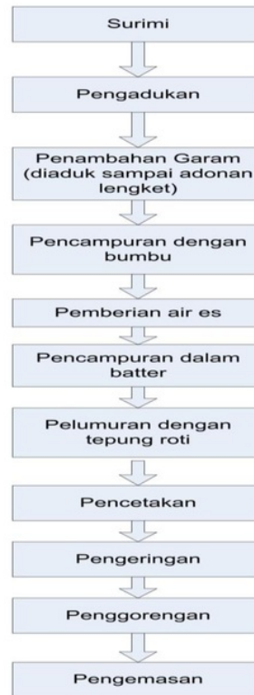
Gambar 6. Alur proses produksi Kerupuk dan Kemplang Sumber : Asmawati, H. Harris, 2017 7)
