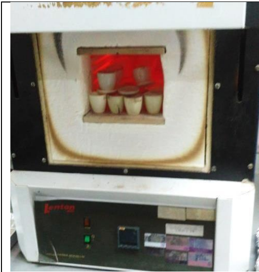
Pengujian kadar abu menggunakan Tanur suhu 700^{\circ}\text{C} \pm 5 jam
