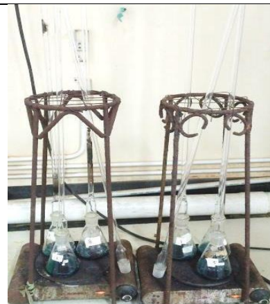
Proses hidrolisis dengan penangas untuk mengetahui kadar gula reduksi
