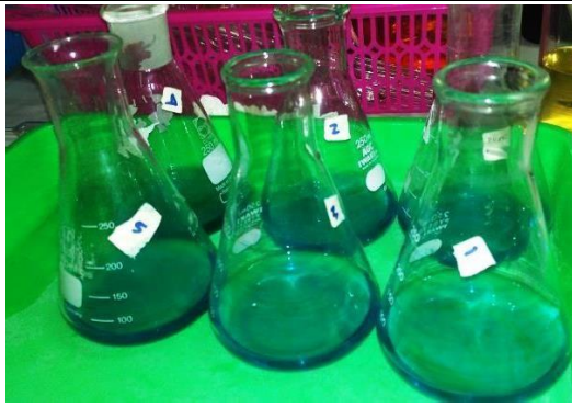
Penambahan luff-schrool sebelum titrasi dengan tio sulfid
