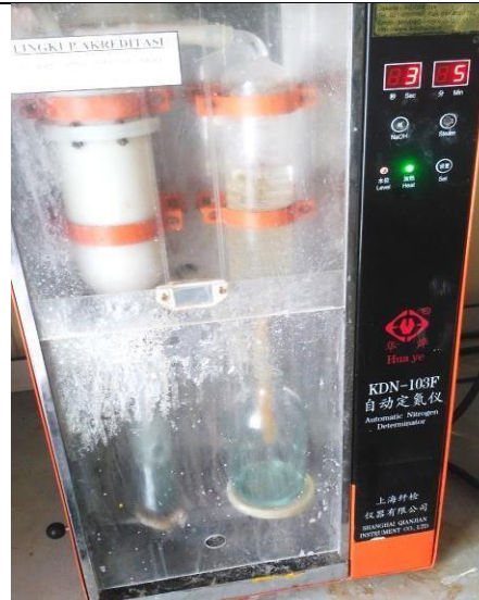
Destilasi menggunakan mesin Nitrogen Determinator
