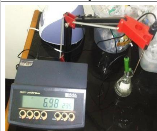
Analisa pH keripik buah dengan pH Meter Digital Hanna Instrument
