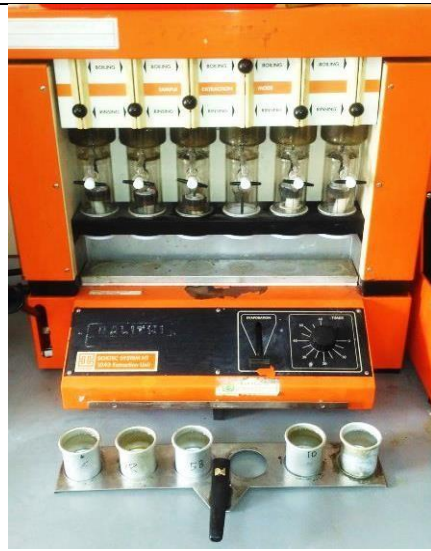
Ekstraksi minyak menggunakan mesin Soxtech (Metode Soxhlet)
