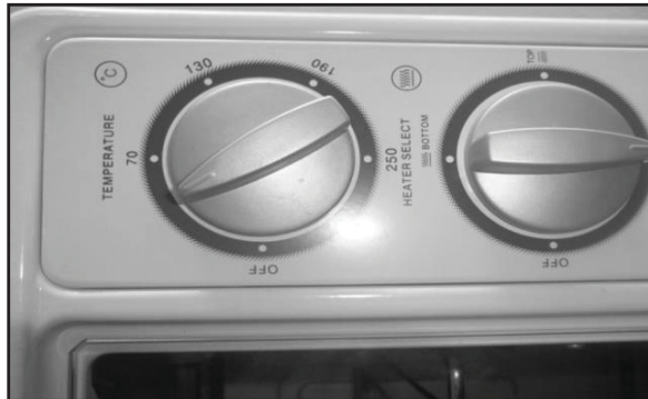
Pengaturan suhu dan lama pengeringan (45 °C, 9 jam)
